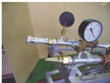
写真は棒状、噴霧の交互、断続放水が可能な実験装置
