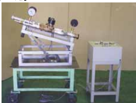
写真は棒状、噴霧の交互、断続放水が可能な実験装置
