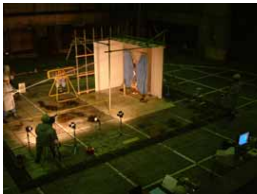
綿カーテンの燃焼・消火実験
